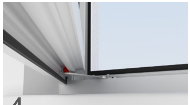
2 Magnetische Fenster-Arretierung im Fensterrahmen ca. 60 mm aus der Ecke heraus platzieren.
